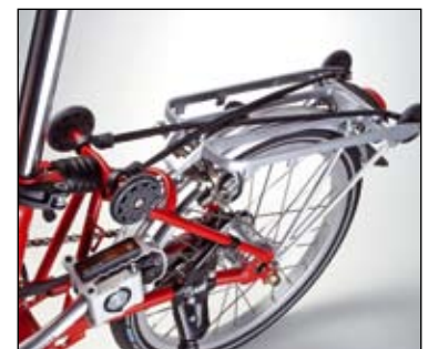
Träger dient eingeklappt auch zum Parken. Rollen erlauben das Schieben.
