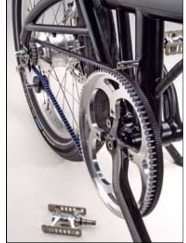
Speziell für Bernds gefertigte Riemscheiben, die vordere ist ein Hingucker!
