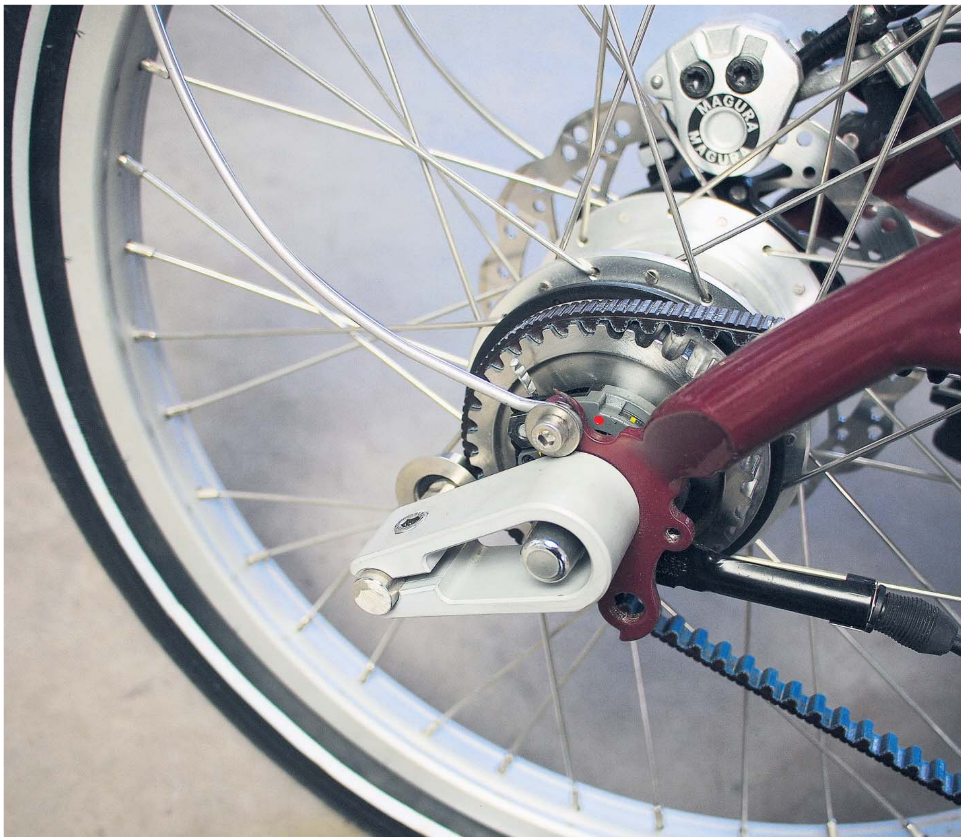
Hier ist äußerste Präzision gefragt: Der blau-schwarze Zahnriemen von Gates verlangt für sein sauberes und leises Funktionieren einen peinlich genauen Einbau.
