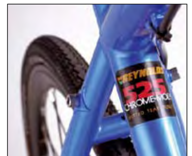
Selten, gut und mit Tradition: der edle Reynolds 525 Stahl-Rohrsatz
