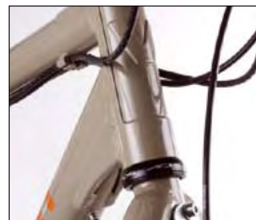
Super gemacht: das CNC-gefräste Bauteil am Steuerrohr.
