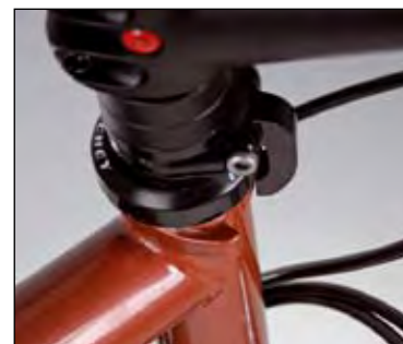
Selten und praktisch: der integrierte Endanschlag für den Lenker
