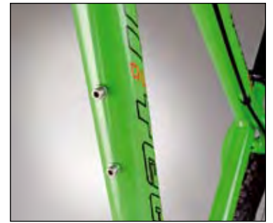
Montageösen unter dem Unterrohr lassen Spielraum für ein Schutzblech.
