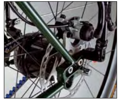
Der Spezialträger (Topeak) schafft Platz für die mechanische Scheibenbremse.
