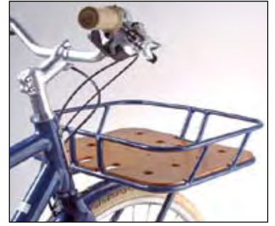
Top: Der mit 20 Kilogramm beladbare Frontträger ist immer im Blick!
